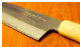
刃の部分になる硬い鋼と、刃体の部分になる柔らかい地金を鍛接して作る堺打刃物。左の写真で刃先あたりのウネウネしているところが鍛接部分である「刃境」。
